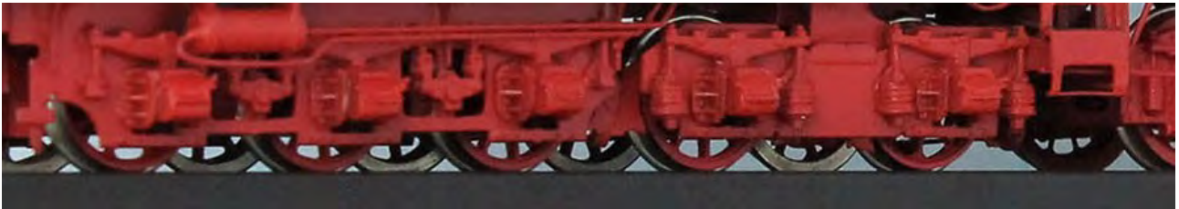
Abbildungen 74. Tenderfahrwerk mit Bremsanlage
