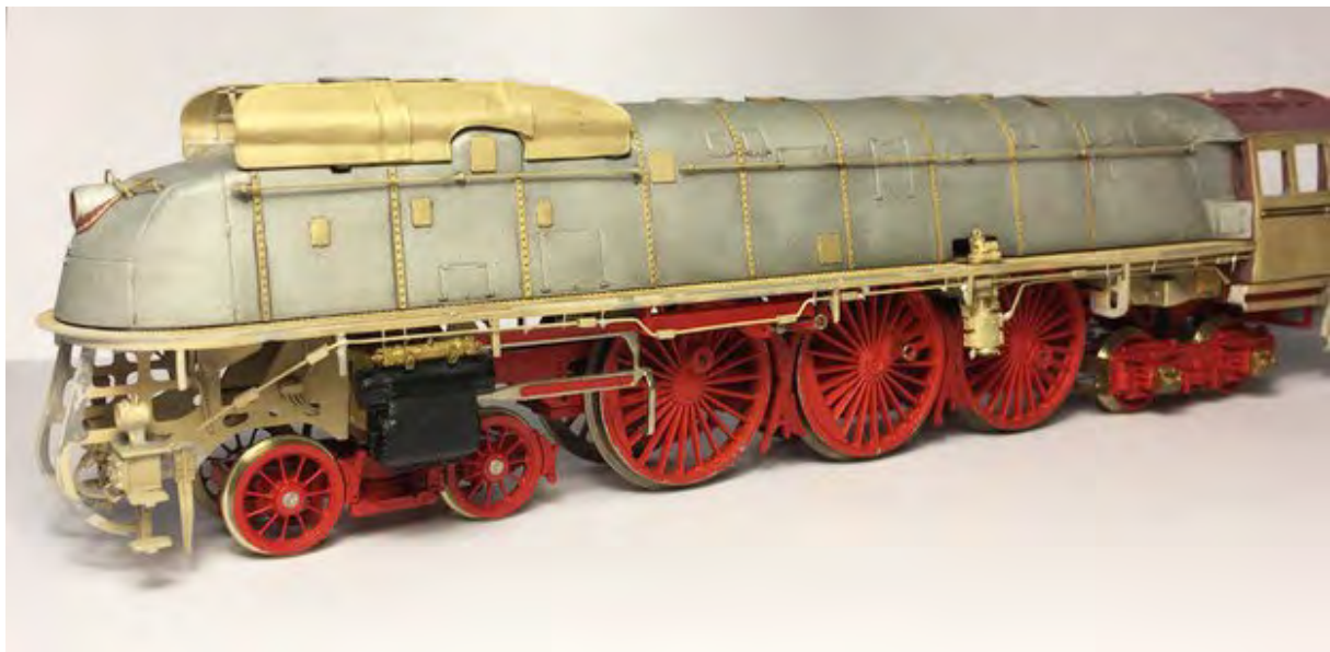
Abbildung 105. 05 002 mit Leitungen und montierter Speisepumpe auf Heizerseite
