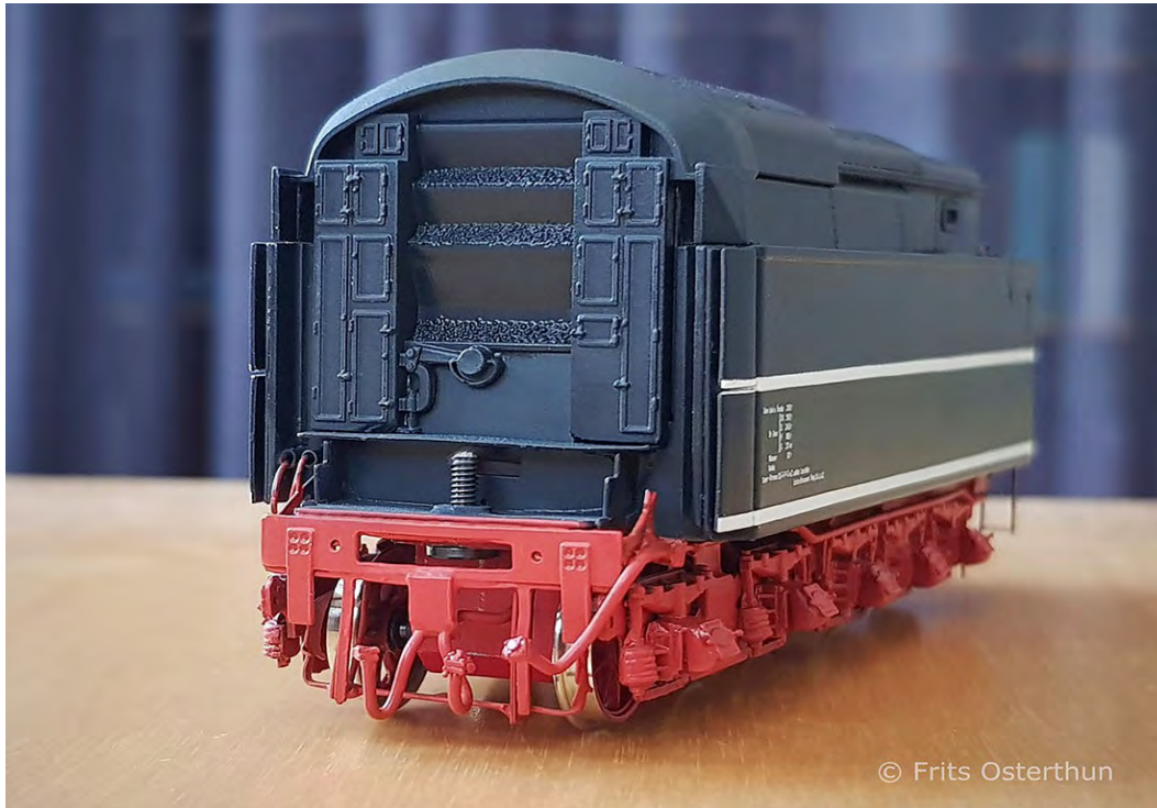
Abbildung 64. Tender 2'3 T37St mit komplettem Kuppelkasten Kuppelkasten nur möglich auf Radien ab 700mm!
