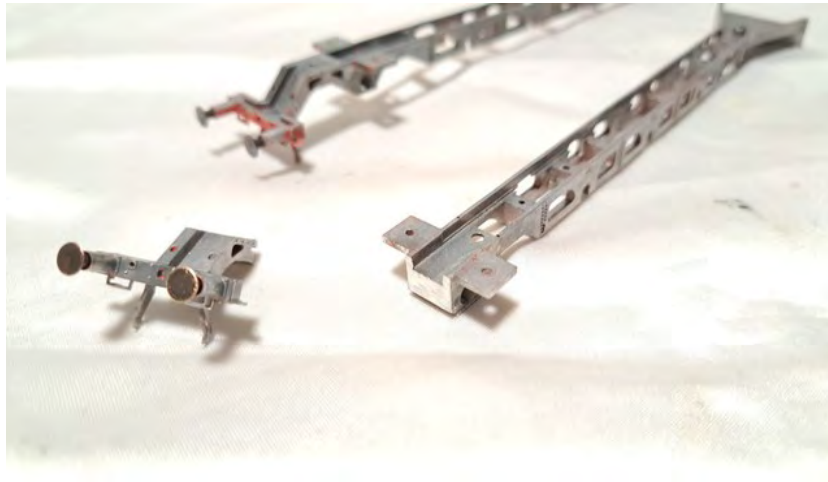
Abbildung 32. Rahmenvorschuh auf Höhe der Zylinder vom Rahmen
