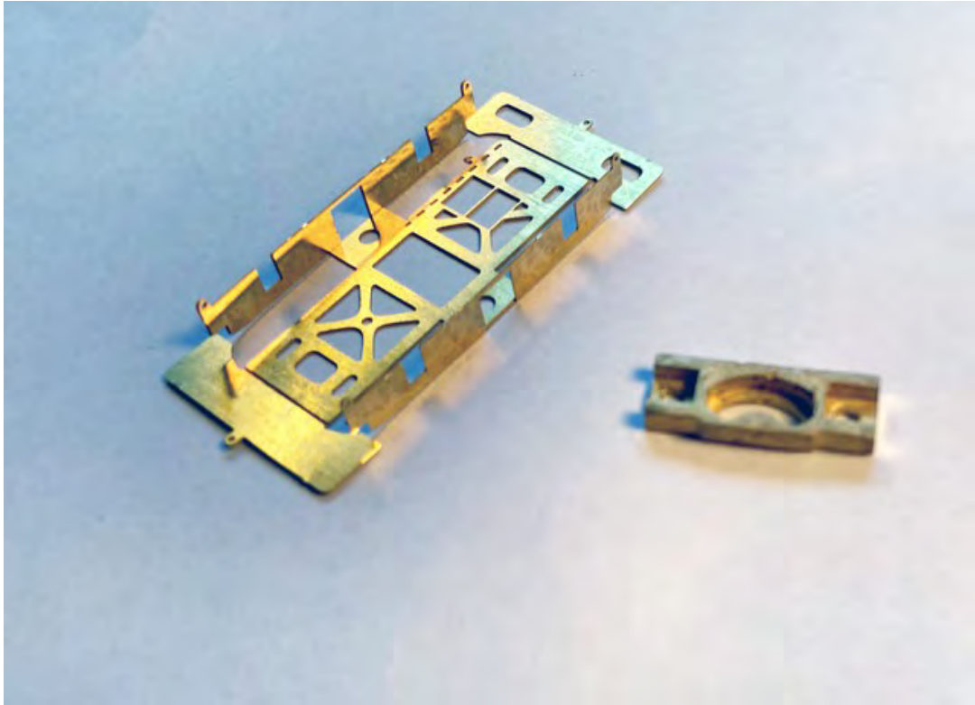
Abbildung 45. Rahmenwangen mit 2mm Achslagern im Winkel von 90Grad biegen
