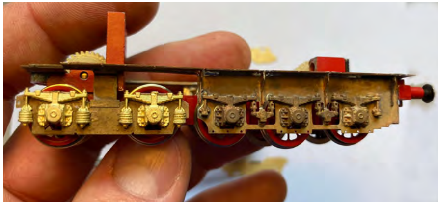
Abbildungen 61 und 62. eingelötete Achslager und Stabilisierungsstreben (grün markiert)
