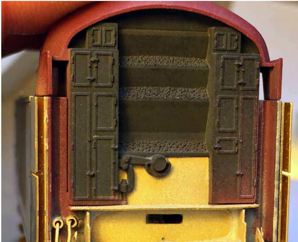
Abbildungen 72. Kohleschütte mit montiertem Kupplungssystem für große Radien
