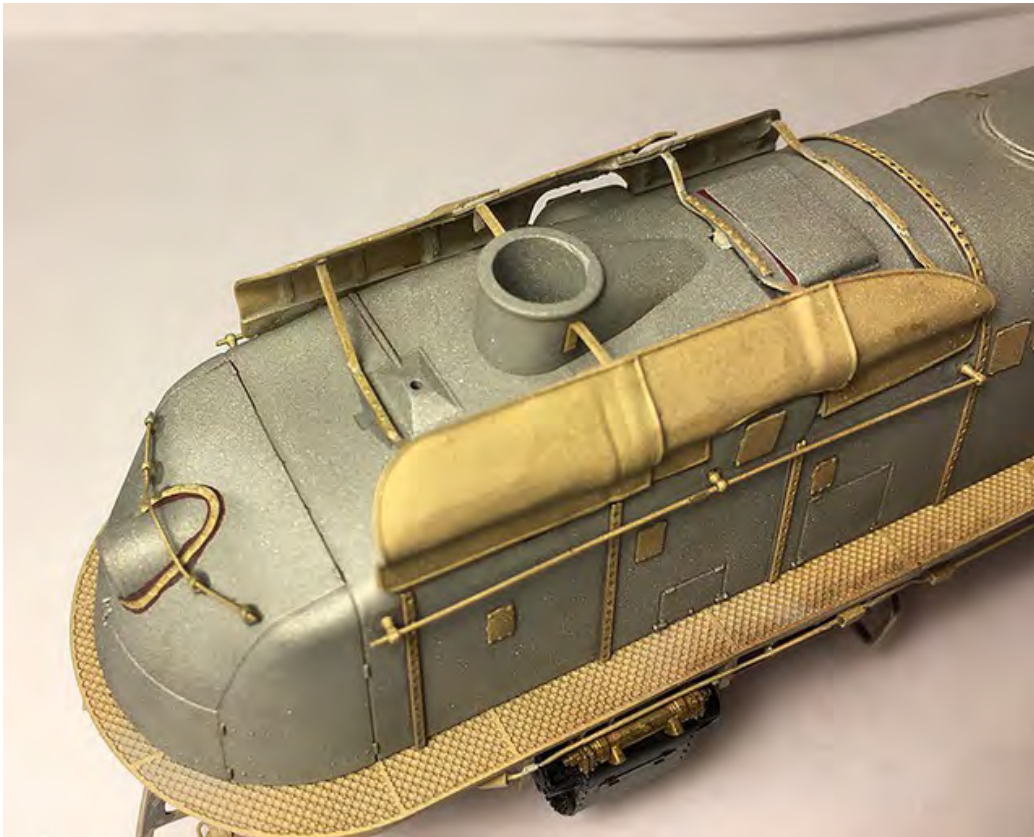
Abbildung 105. 05 002 mit Leitungen und montierter Speisepumpe auf Heizerseite
