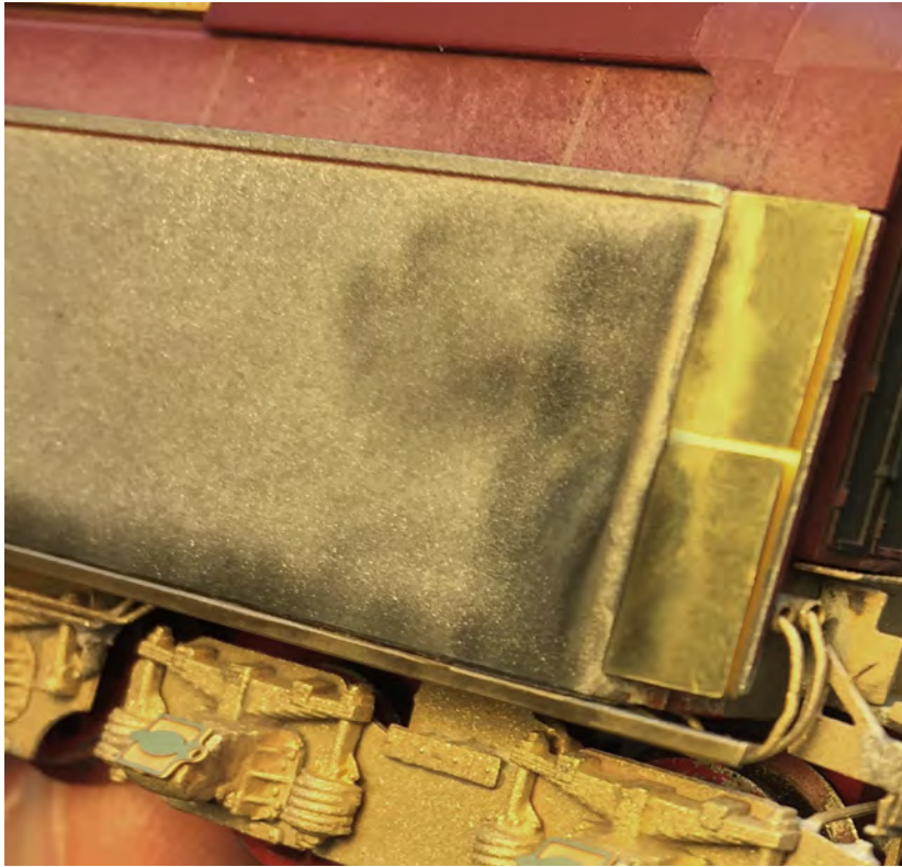
Abbildung 83. Leitung mit Vierkant Rohrflanschen auf der Heizerseite verlegen. Für genau Lage der Leitungen bitte Vorbildliteratur beachten.
