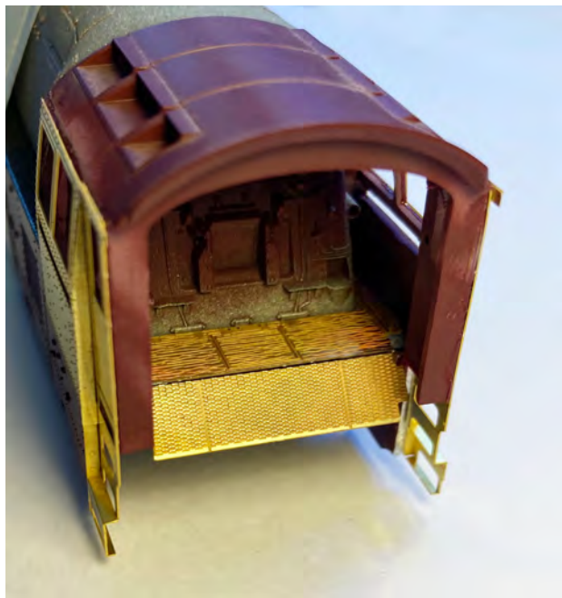
Abbildung 53. Führerhaus mit eingesetzter beweglicher Tenderbrücke
