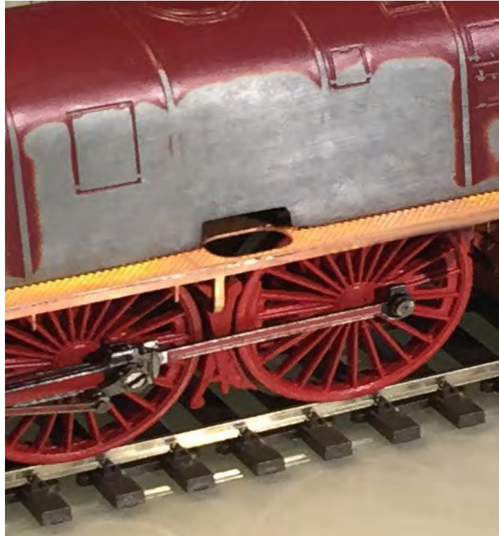
Abbildung 28. Verkleidung von Speisepumpe entfernen
