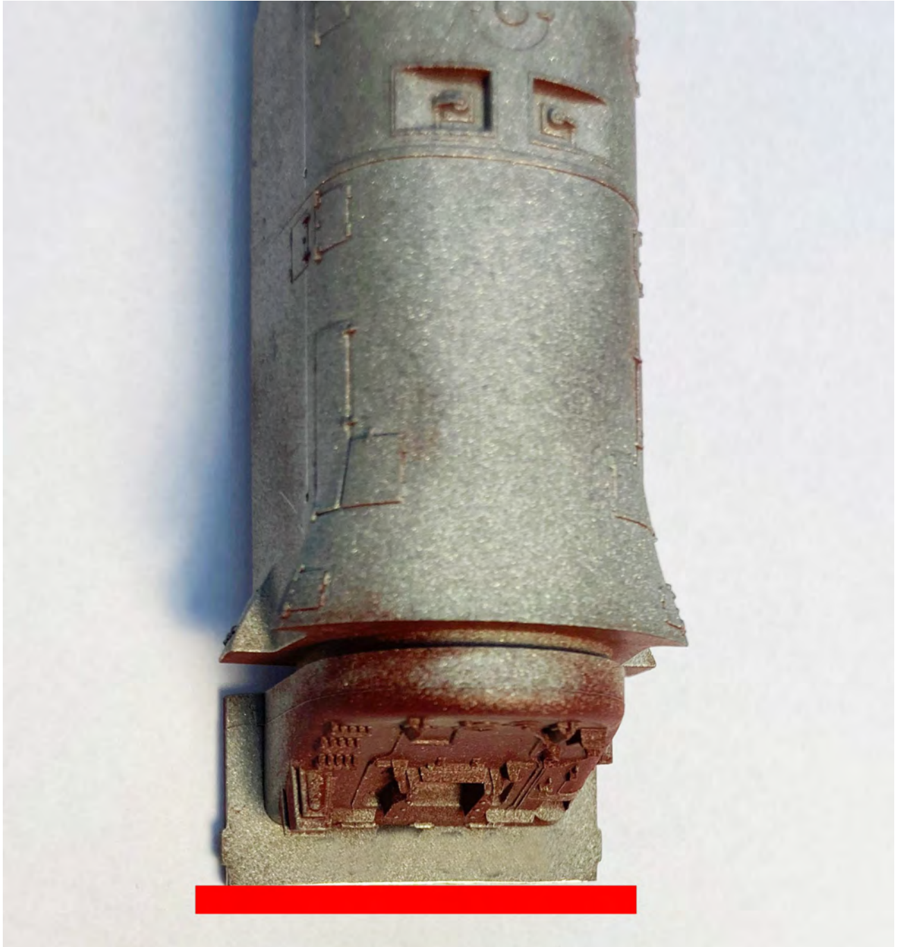
Abbildung 31. Führerhausboden kürzen bis auf Höhe der Türen
